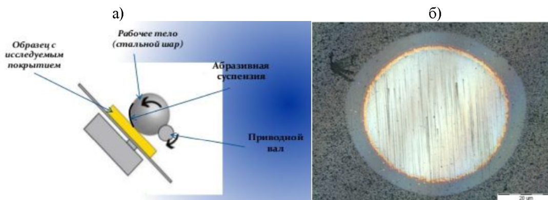
Рис.1. Методика получения сферического шлифа: а – схема процесса; б – изображение шлифа, получаемое при помощи оптического микроскопа
