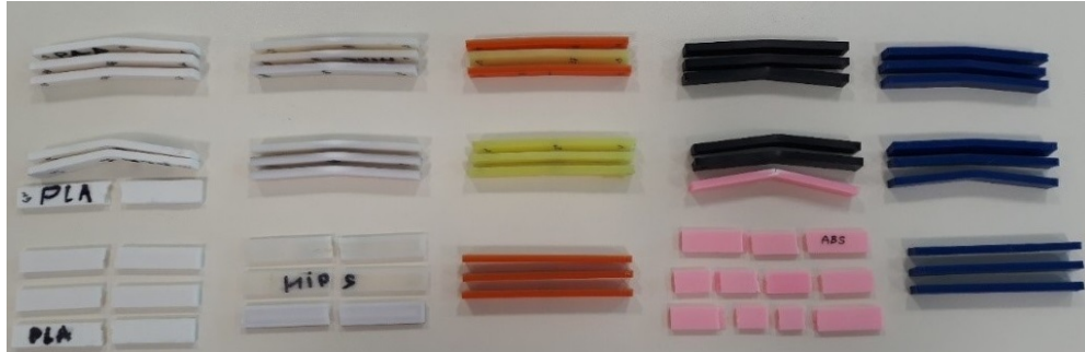
Рис. 2. Образцы после испытаний на изгиб: сверху-вниз: при +22 °С, 0 °С, - 40 °С; слева-направо: PLA, HIPS, SBS, ABS, PETG
