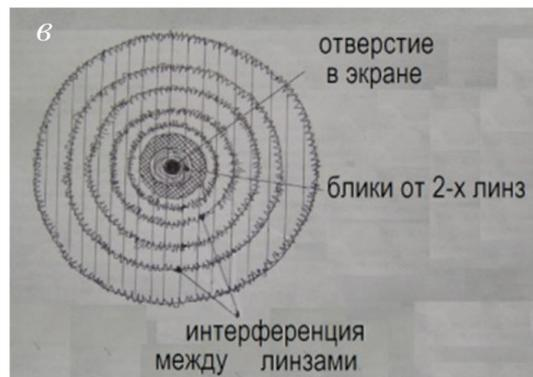
Рис. 16. Появление картинки интерференции при совмещении бликов. Блики только от положительной линзы: разведены (а), совпадают (б). Блики от четырех поверхностей двух линз совпадают (в)
