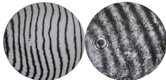
Рис. 2. Интерферограмма волнового фронта телеобъектива и телескопа [Клевцов, 1987]. Волновой фронт телескопа близок к теоретическому пределу
