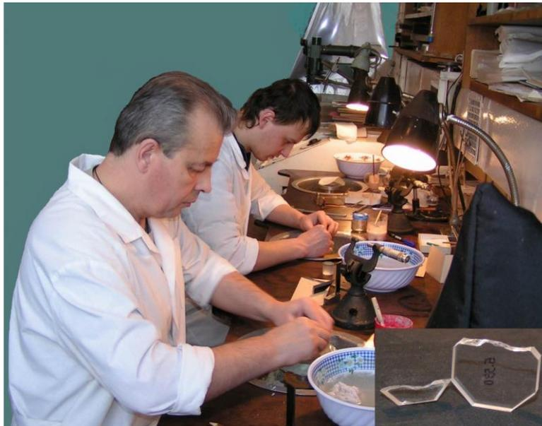
Рис. 4. Оптички Химич В.А., Иванов А.А. за изготовлением пластинок для ИПФ. В правом нижнем углу показана пластинка, разрушенная из-за перегрева в ИПФ. Волнистая линия разлома — свидетельство неравномерного нагрева (термического удара)
