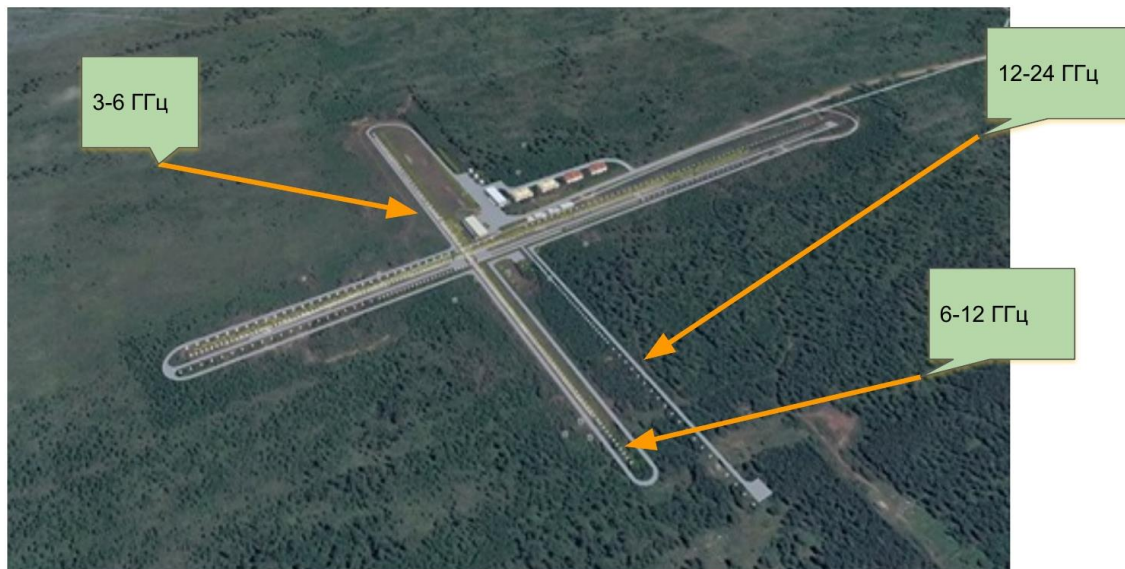
Рис. 1. Схема расположения антенных решеток Сибирского радиогелиографа
