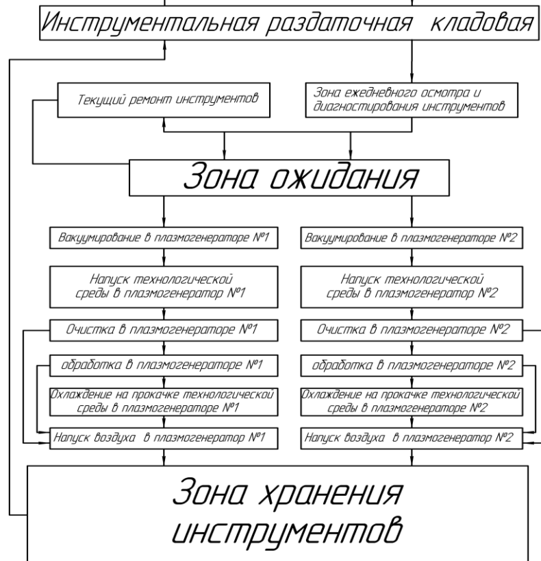
Рис. Алгоритм функционирования инструментального участка по упрочнению инструментов в плазмогенераторах тлеющего разряда
