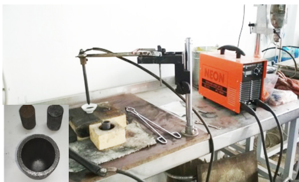
Рис. 2. Плавильная электродуговая установка для высокотемпературной микроплавки на основе сварочного инвентора. Тигель и брикеты (слева внизу)
