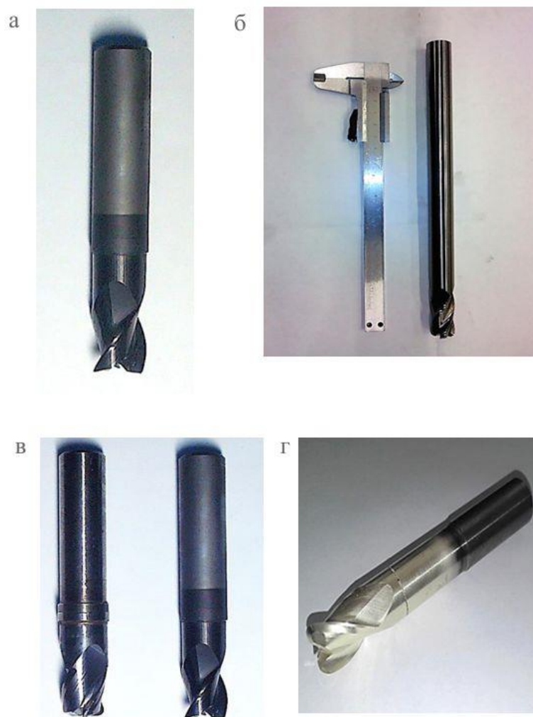
Рис. 3. Примеры составных фрез длиной 92 мм
