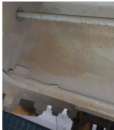
Рис. 1. Коррозионные пятна на хребтовой балке плацкартного вагона
