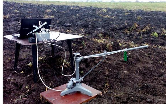
Рисунок 5 – Общий вид изготовленного бесконтактного устройства на склоне
