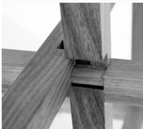
Рис. 2. Деревянный узел Сидори
