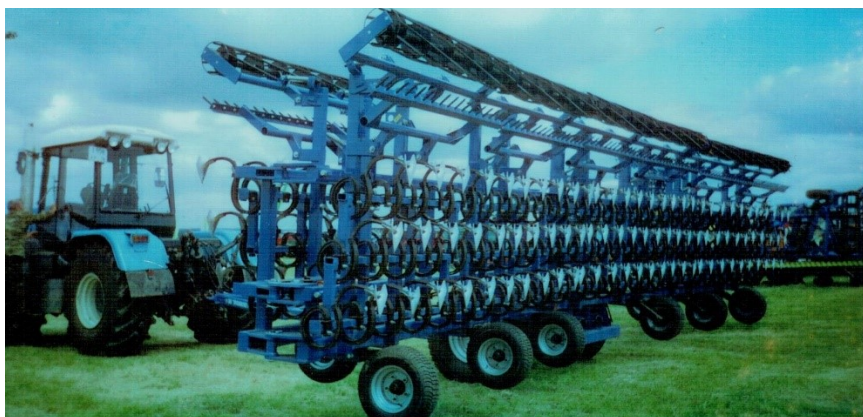
Рис.4 – Рамные конструкции широкозахватных блочно-модульных культиваторов для тракторов минимального тягового класса
