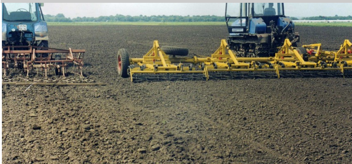
Слева – КПС-4+4БЗСС-1+шлейфы: глыбистость и гребнистость 7 см не отвечают агротребованиям посева зерновых. Справа – КБМ-15П: глыбы и гребни отсутствуют, выровненность – 100%. Посев возможен на 2 см
