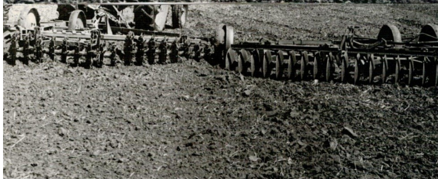
а – борона коническая ПБЛ-10; б – сравнение на аэрационном бороновании многолетней травы: слева – ПБЛ-10, справа зубовая борона БЗТС-1; в – сравнение на бороновании зяби: слева – БЗТС-1, справа – ПБЛ-10; г – сравнение на лушении: слева – ПБЛ-10, справа – луцильник ЛДГ-5 Рис.2 – Сравнительные испытания почвообрабатывающих машин
