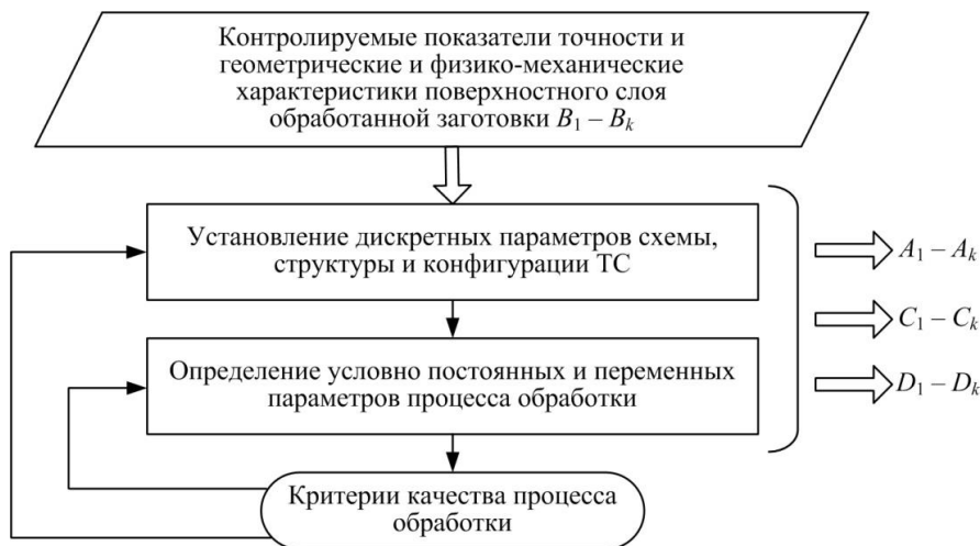
Рис. 2. Алгоритм проектирования технологической операции в обобщенном виде Fig. 2. Algorithm for designing a technological operation in a generalized form
